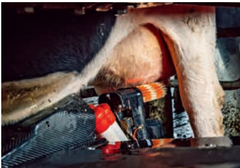
Alles im Griff: Dank Lasermessung findet der Melkroboter das Euter der Kuh.
